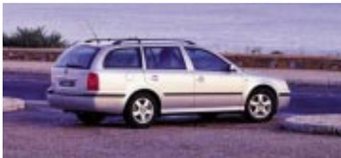
Le Combi 4x4 s'articule sur la plateforme de la Golf, reçoit le moteur de 74 kW et une transmission intégrale identique à celle de l'Audi S3 ou de la Golf 4Motion.
